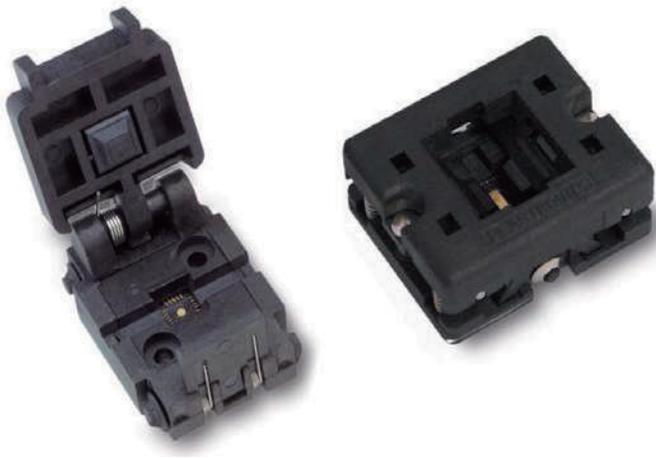
在针对最新型QFN封装(如MLF、BCC和LPCC)插座解决方案的设计和开发方面,史密斯英特康的产品引领市场。这些插座在小尺寸外形的条件下实现了模块化设计理念,而且电感非常低。
